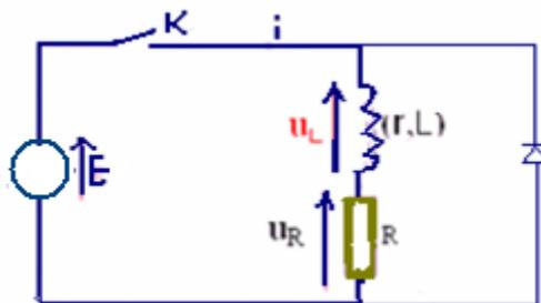
$$\text{En appliquant la loi d'additivité des tensions on a } u_L + u_R = 0 \Rightarrow (L \frac{di}{dt} + ri) + Ri = 0 \Rightarrow L \frac{di}{dt} + (r+R)i = 0$$
