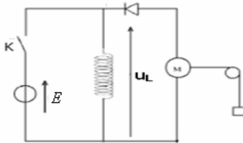
On ferme l'interrupteur k à l'instant  $t=0$ , un courant électrique traverse la bobine car la diode est bloquante, elle empêche le courant de passer dans le moteur puis on ouvre l'interrupteur, on constate que le moteur fonctionne et le corps suspendu au fil monte d'une hauteur h.
