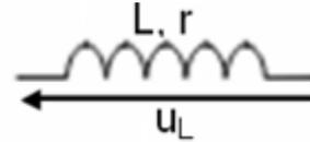
**En convention récepteur, l'intensité i du courant et la tension  $u_L$  aux bornes de la bobine sont représentées par des flèches de sens contraires.**
